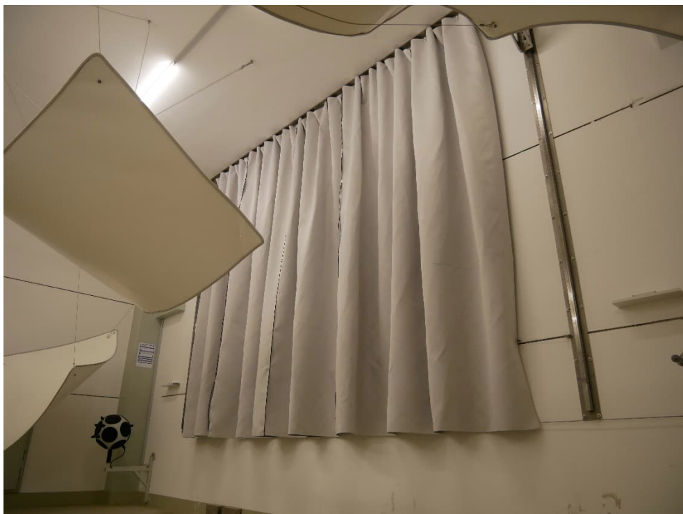
Abbildung B.2. Prüfanordnung im Hallraum (diagonale Ansicht).
